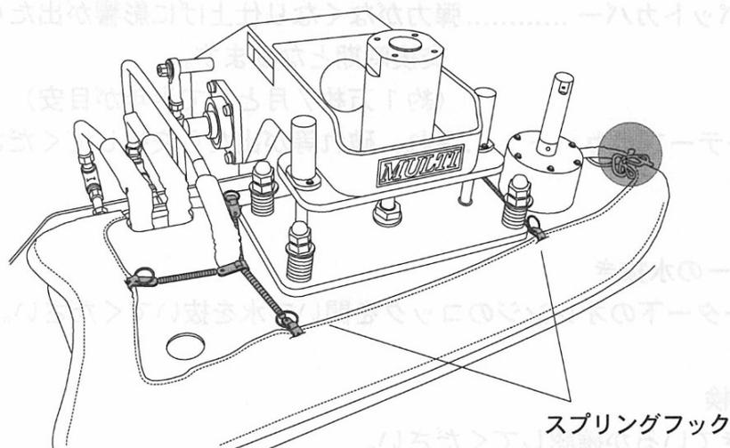
外したパットカバーからステンレス棒を2本抜き取り
