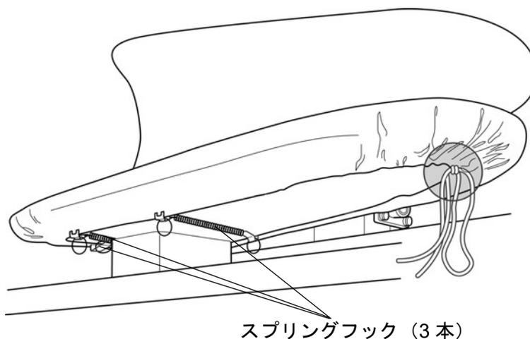
外したパットカバーからステンレス棒を2本抜き取り新しいパットカバーに差し込み、
