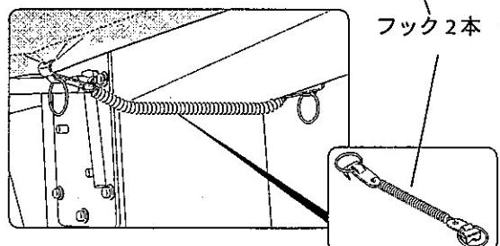
4. フック(2本)をカバー内のSUS棒に引っ掛け、セットしてください。（図を参照）
