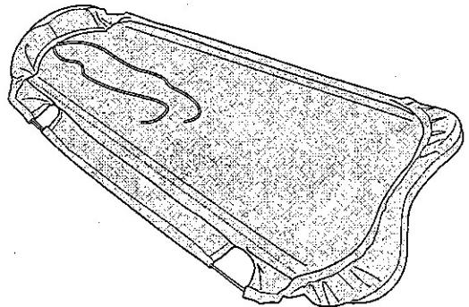
2. 下コテカバーをセットしてください。下コテにカバーをかぶせて先端中央のひもを引っ張り、シワがないようにセットしてください。（前図を参照）
