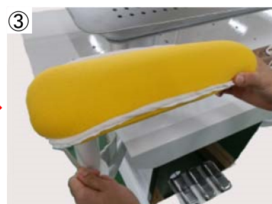
袖台をシリコンマットカバーの紐で引っ張りながら覆ってください。
